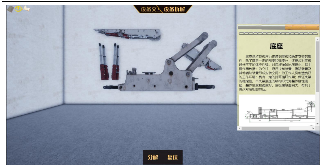
图 27 放顶煤液压支架拆解结构
