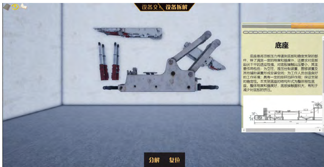
图 27 放顶煤液压支架拆解结构
