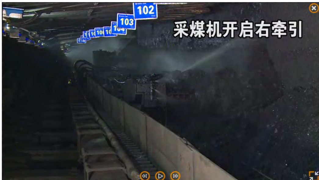
图 39 综采放顶煤工艺视频
